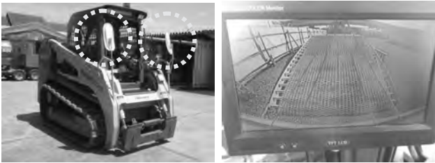
写真-6 安全補機類 (バックミラーとバックモニタ)
