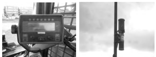
写真-5 制御装置とレーザ受光器
