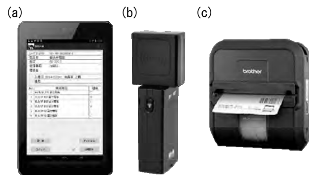
図-5 システムで使用する携帯端末。(a) タブレット (Google 社製 Nexus7), (b) タグリーダー (D.O.TEL 社製 DOTR-910J), (c) ラベルプリンター (ブラザー 社製 RJ-4030)。
