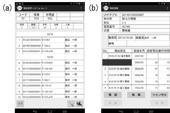
図-3 タブレットの画面の例。(a) 整備された製品を一覧表示している。(b) 分電盤の検査データを入力する画面。矢印の行は、この部品が品質基準を満たしていないことを強調表示している。
