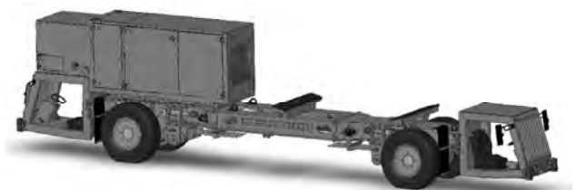
図-4 前後に運転席が配置された坑内搬送台車
