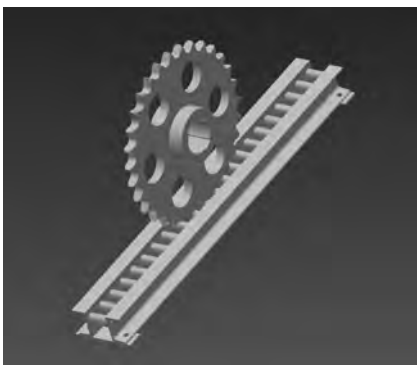
図-2 第3軌条（ラック式レール）
