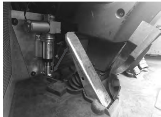
写真-7 パワーシリンダを使用したブレーキアシスト装置
