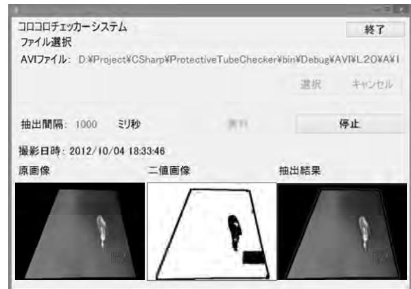
図-6 損傷箇所検出画面
