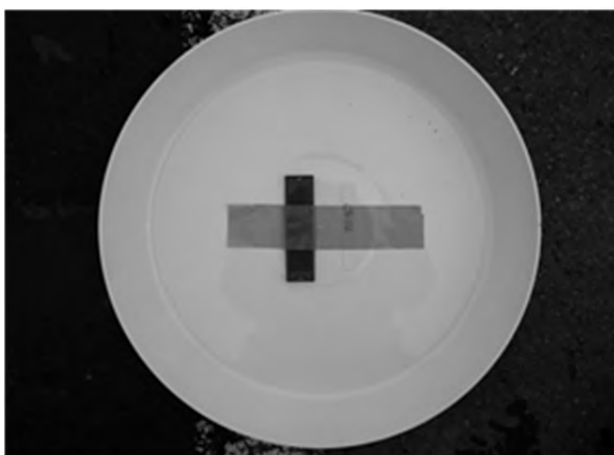
写真-2 ケース内へのICタグ取付状況 (この後、アスコン打設)
