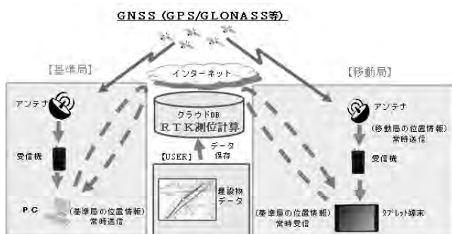
図-1 機器構成と通信イメージ
