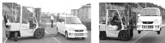
写真-2 フォークリフトでの乗用車の持ち上げ作業
