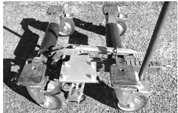
写真-8 改造後の車両移動用ジャッキ（旧型）
