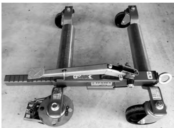
写真-9 改造後の車両移動用ジャッキ（新型）
