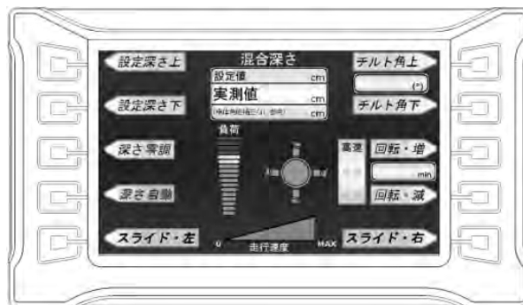
図-3 混合深さ自動制御システムパネル
