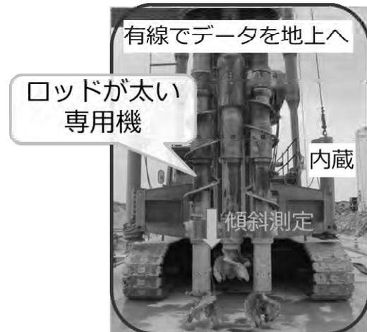
写真-1 山留め出来形計測専用機
