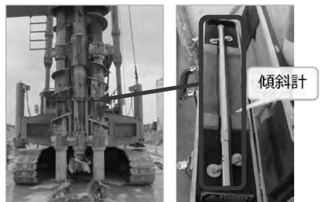
写真-2 山留め出来形計測専用機
