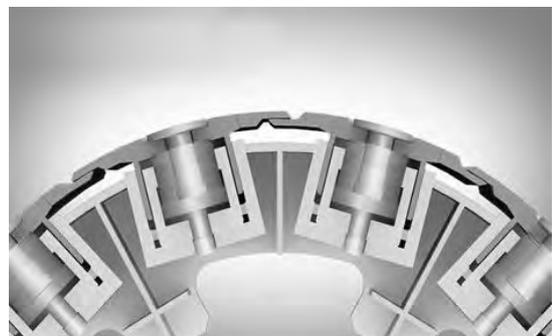
図-6 外鋼殻継ぎ目部構造
