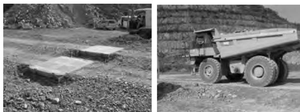
図-2 携行式トラックスケール(一軸)による計量例
