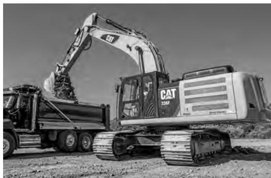
図-1 Cat プロダクションメジャメントを搭載した油圧ショベル Cat 336F(L)XE
