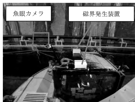
写真-1 機器設置状況（運転室屋根）
