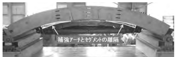
写-1 荷重試験後の状況
