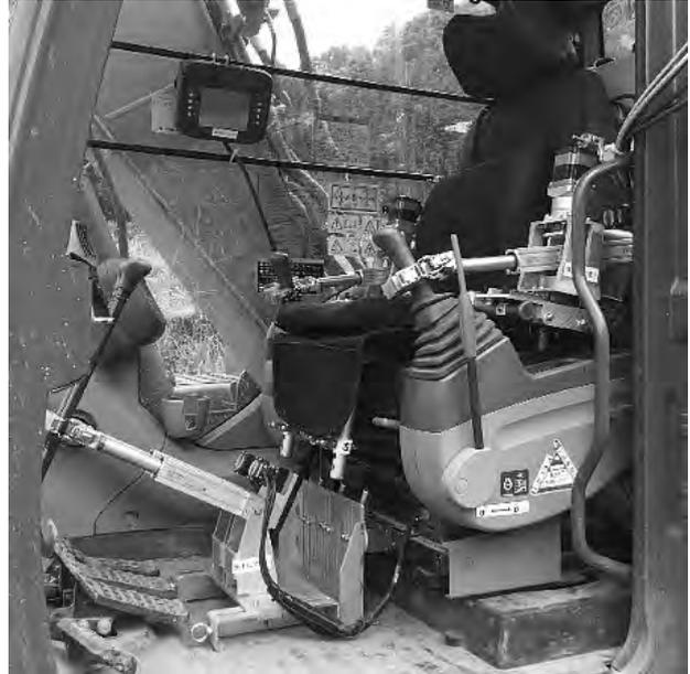
写真-10 ロボ QS 搭載状況
