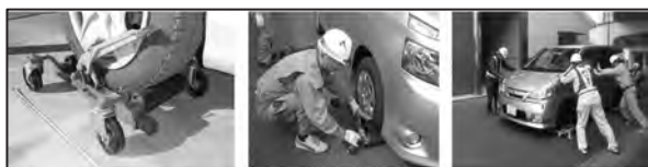
写真-4 車両移動用ジャッキによる乗用車の移動作業
