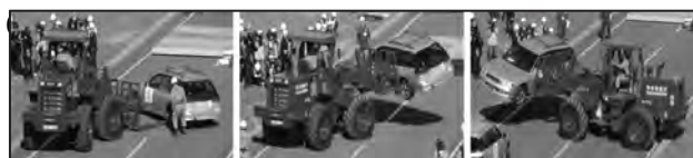
写真-3 ホイールローダによる乗用車の持ち上げ作業
