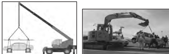
写真-5 クレーン装置による乗用車の吊り上げ作業
