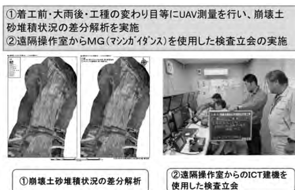
図-14 管理、検査におけるi-Constructionの取組み
