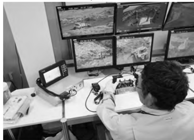
写真-6 ブルドーザ排土板制御システム使用状況
