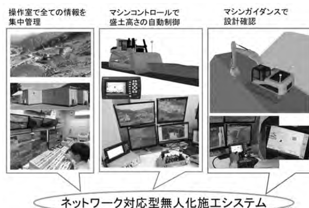
図-11 ICTを導入した無人化施工システム
