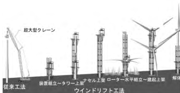
図-1 施工ステップ
