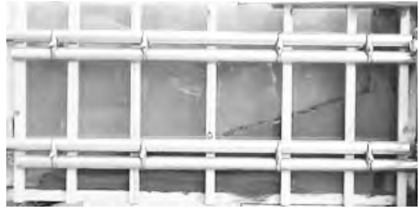
写真-1 型枠内流動実験の測定画像の例（1回目、50s）
