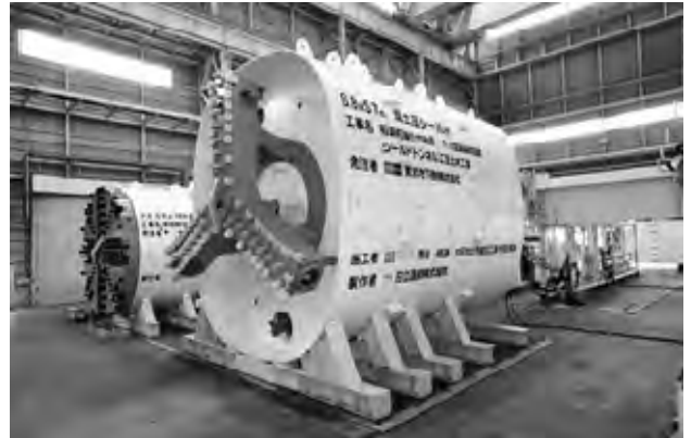
写真-3 シールド全景
