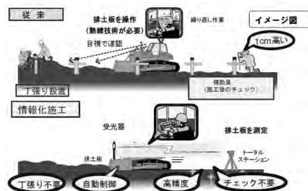
図-1 従来工法と情報化施工の比較 1)
