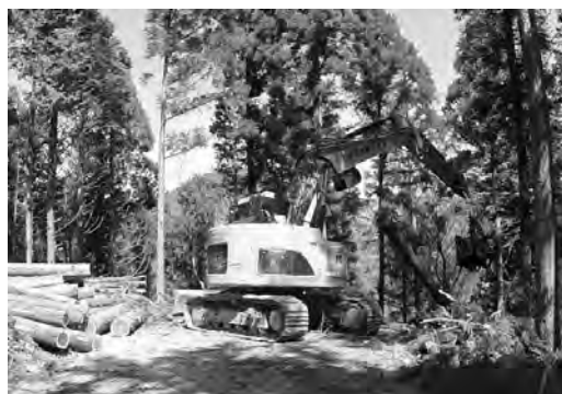
図-9 プロセッサ・ウインチによる木寄せ状況
