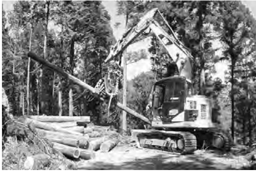
図-10 プロセッサによる造材状況
