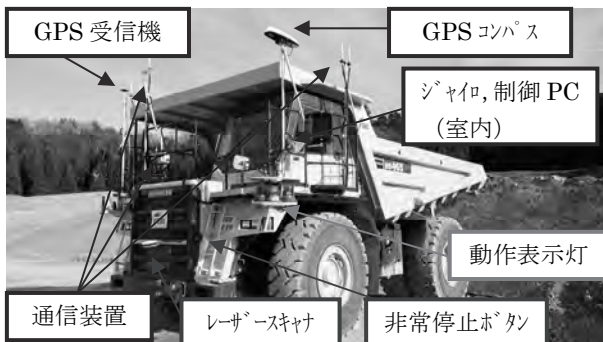
写真-6 自動化機器の配置(ダンプ外観)
