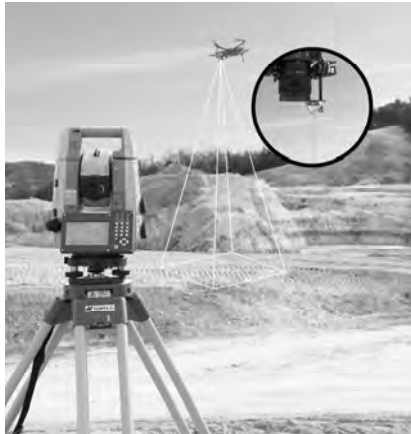
図-3 自動追尾TSを用いたカメラ位置計測
