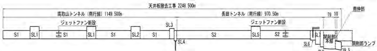
図-4 南行線（上り）トンネル断面区分
