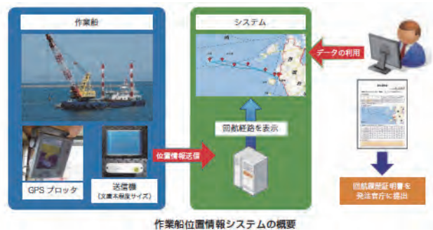
図-3 作業船位置情報システムの概要
