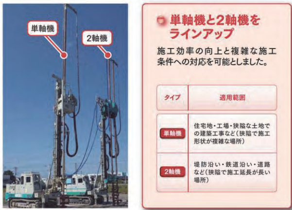
図一4 施工機のタイプと適用範囲
