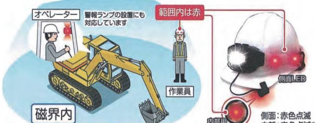
約4~14mの範囲で段階的に調整可能
