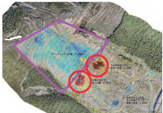
図-18 施工前後の土砂差分解析結果
