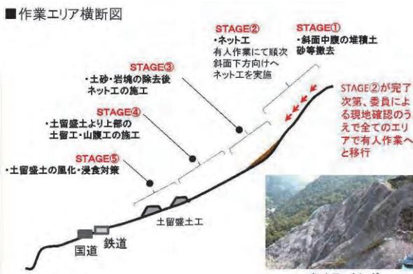
図-4 作業エリア横断図
