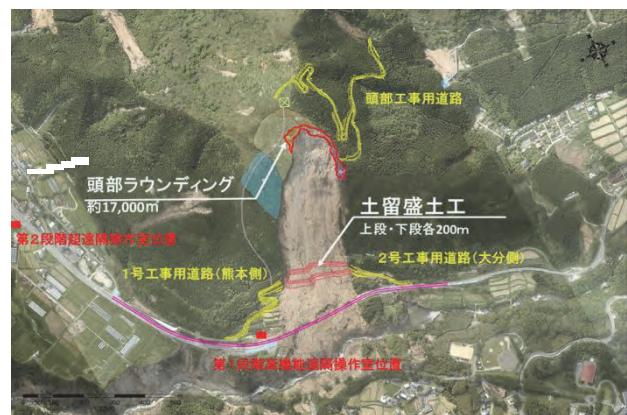
図-2 緊急対策工事全体概要図
