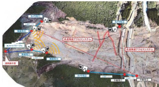
図-14 無人化施工設備配置図
