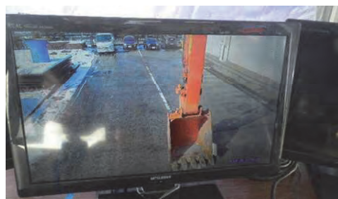
写真-1 履帯が確認出来ない状況
