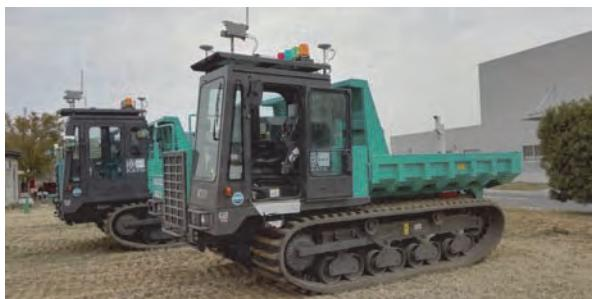
写真-1 実験に使用した不整地運搬車
