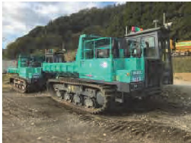
写真-1 自動走行対応型不整地運搬車
