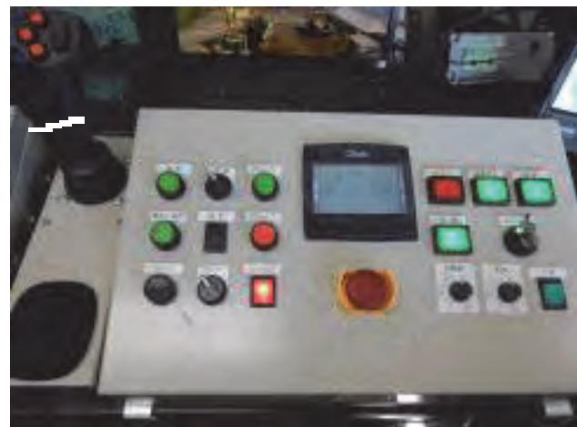
写真-3 遠隔・自動操作盤
