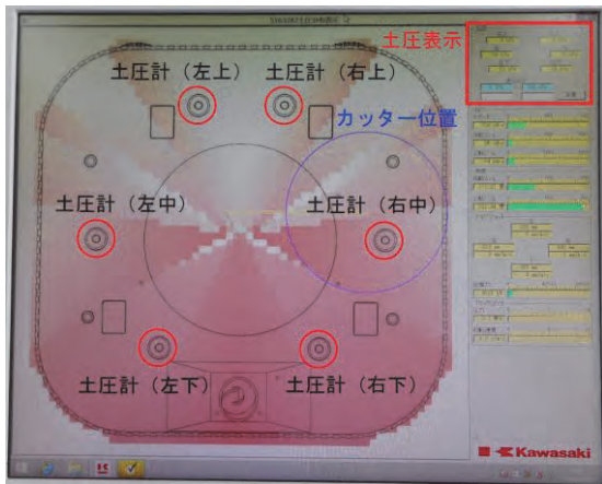
写真-3 土圧分布監視モニター
