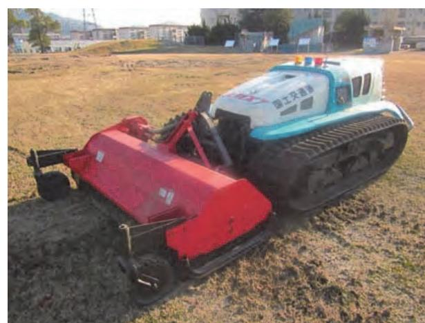
写真-1 大型遠隔操縦式草刈り機
