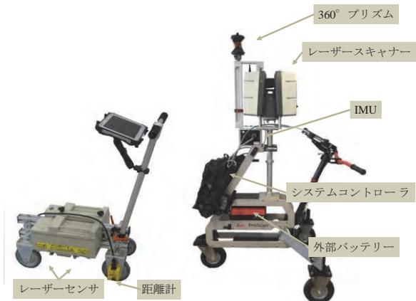
写真-1 MRP(左) Leica ProScan(右) 外観
