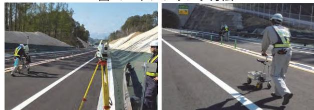
写真-2 Leica ProScan(左) 及び MRP(右) 測定状況
