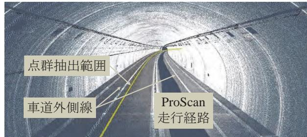
図-5 Leica ProScan 測定イメージ図
