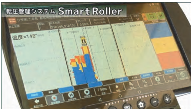
写真-13 クラウド型転圧管理システム 画面表示
