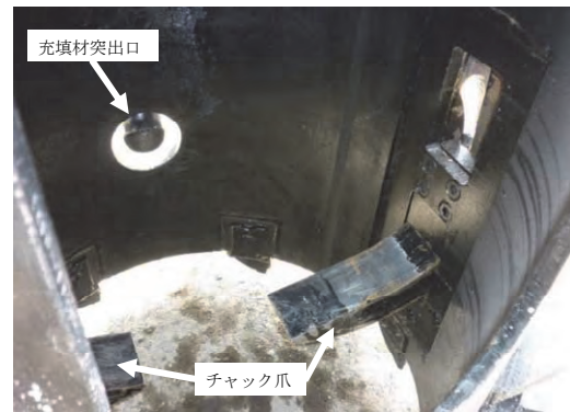
図-4 チャック爪の突出
