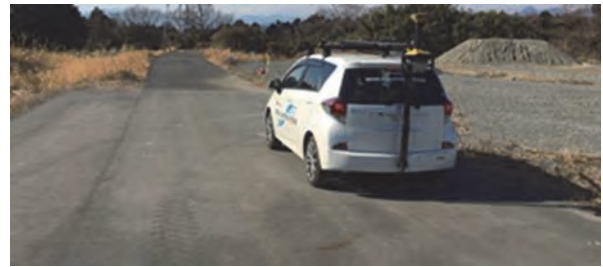
写-2 移動式路面計測装置計測状況
