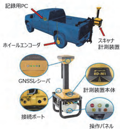
図-11 RD-M1 システム構成
