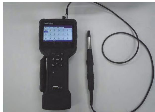
図-5 SPM 計測装置
