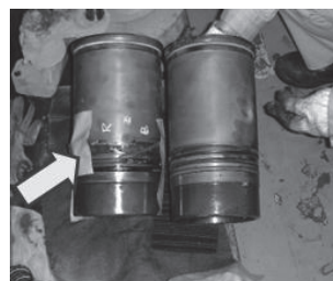
図-3 クレビスシール破損状況
