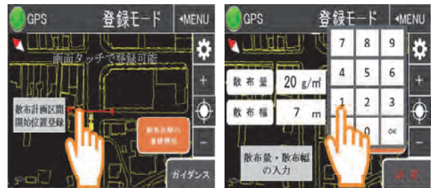
図-8 改良後 ガイダンス情報登録・編集機能
