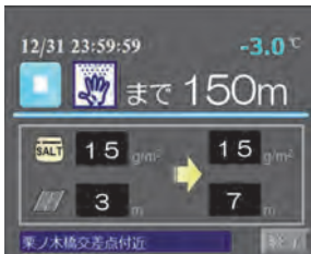
図-4 改良前 散布ガイダンス画面
