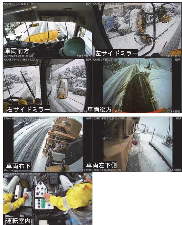
写真-4 ドライブレコーダ撮影画面(7箇所)
