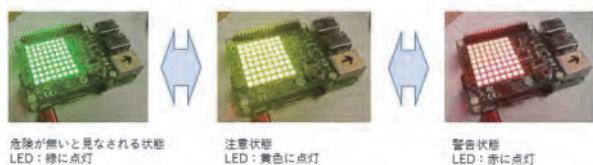
Fig. 1 転倒警告システムの稼働イメージ
