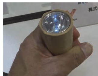
図-12 体温の熱で発電できる熱発電素子。
