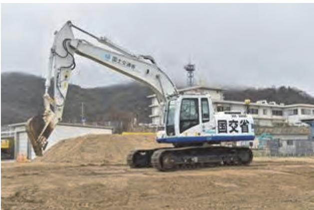
写真-1 分解組立型バックホウ
