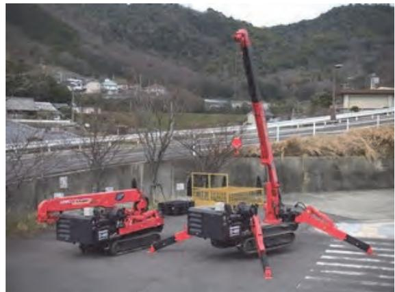
写真-2 ミニクローラクレーン
