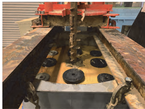
写真-4 上載圧を加えた室内模型実験
