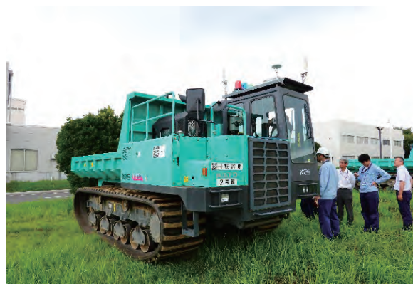
写真-4 使用した不整地運搬車
