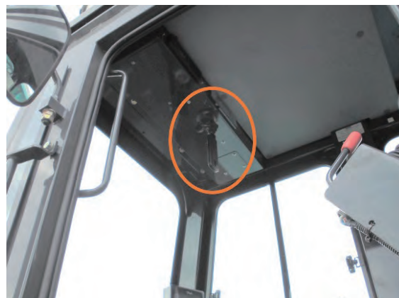
写真-5 360度カメラの取り付け
