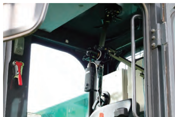
写真-8 360度カメラの取り付け
