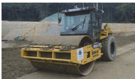
図-1 自立制御型振動ローラ
