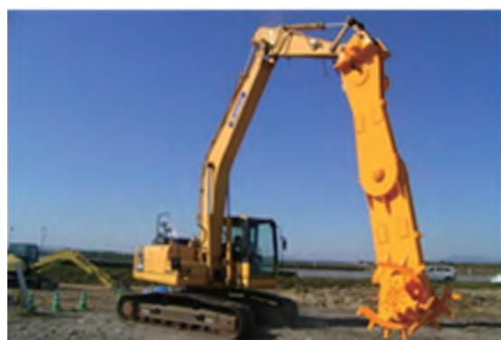
写真-1 WILL 工法施工機
