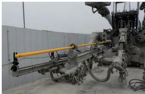
写真-2 モルタル注入装置全景
