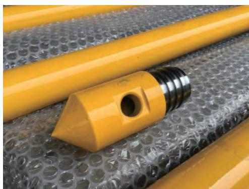
写真-3 モルタル注入装置先端
