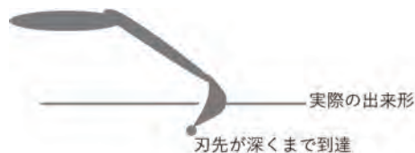
図 5 土は掘られていなくとも刃先が深く刺さったため出来形が低く見積もられる
