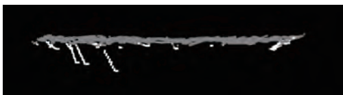
図 6 施工履歴による出来形(横から) 較差-100 mm を越える点は白色で表示
